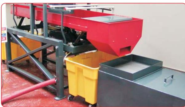
Voda sa cez filter vracia do zbernej nádrže. Zvyšky mechanických prímesí sa usadzujú v sedimentačných komorách nádrže. Voda sa vracia späť do procesu
